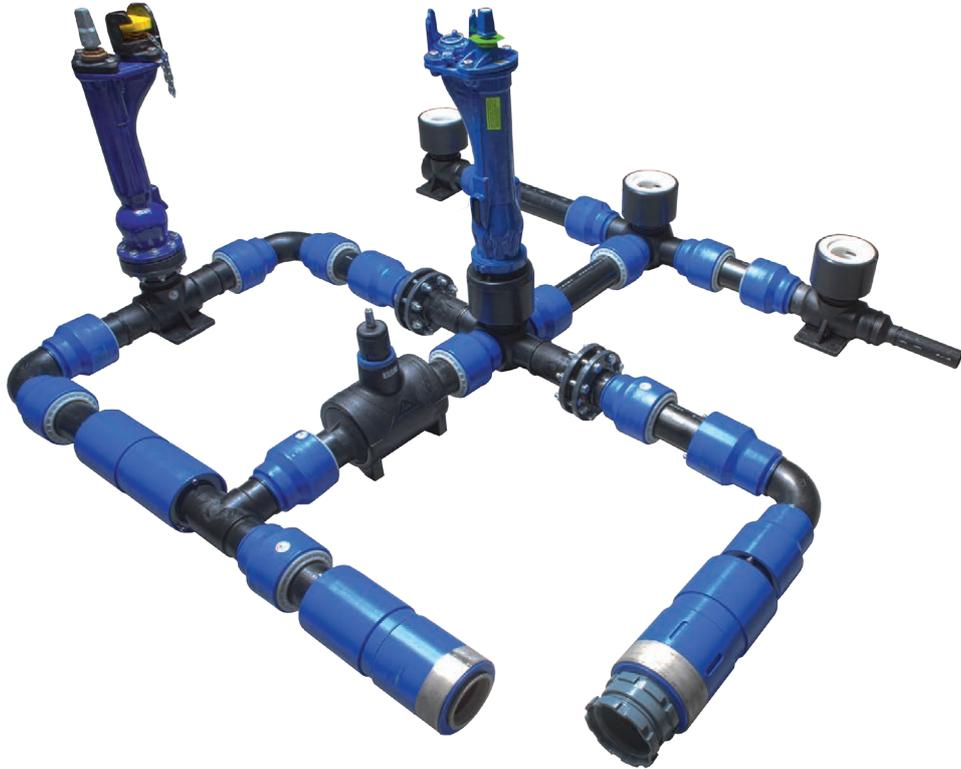
Mit dem REINOGRIP Konzept steht den Anwendern ein vielfältiges Formteilprogramm bestehend aus E-Stücken, T-Stücken und Bögen in unterschiedlichen Ausführungen zur Verfügung. Unsere REINOGRIP Produkte sind druckbelastbar bis 16 bar. Die Dimensionen reichen von d 90 bis hin zu d 450 mm.
